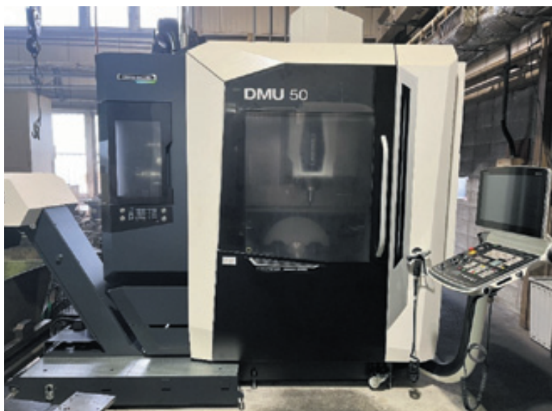
株式会社田口鉄工所に設置してある5軸制御マシニングセンタ(左)と小型6軸制御産業用ロボット
